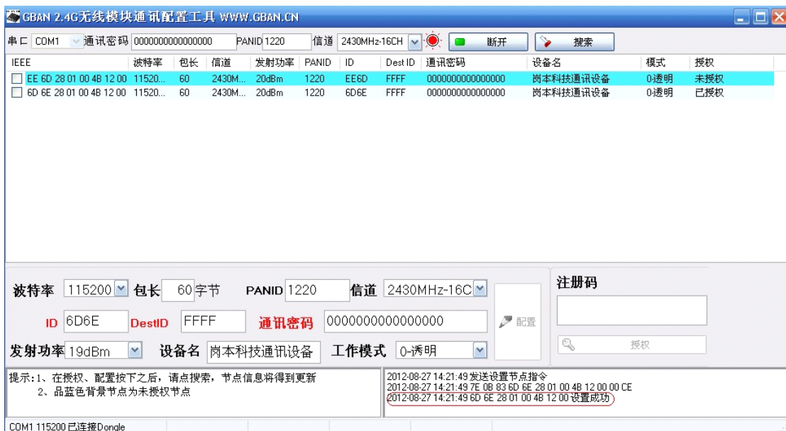
图 3.5 GB_RFconfig 配置节点示意图
