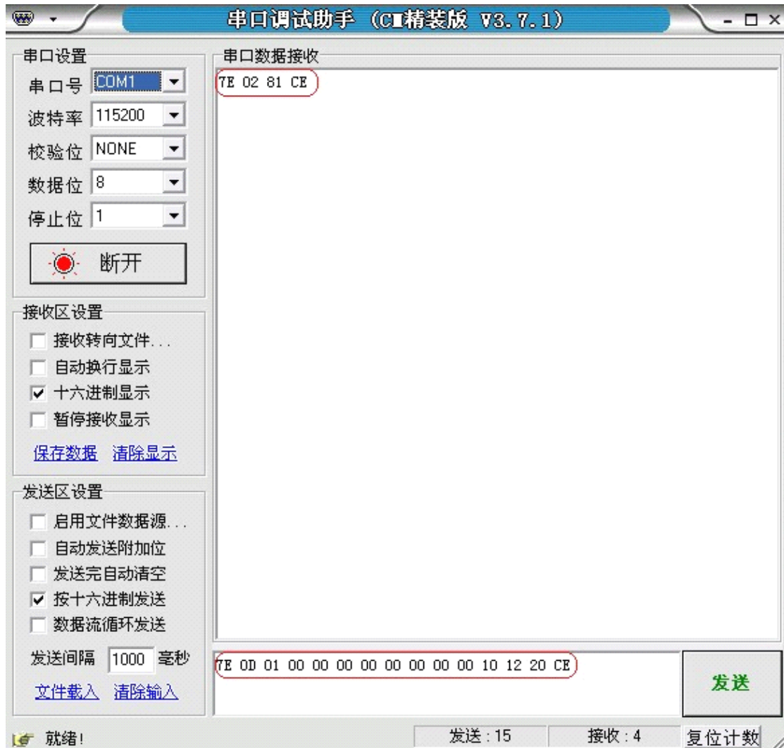
图 4.2 设定 Dongle 工作参数
